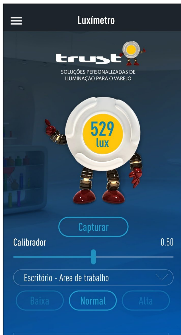
Figura 14 – Medição do nível de iluminação na bancada de trabalho, utilizando o aplicativo Dr. Led®.
